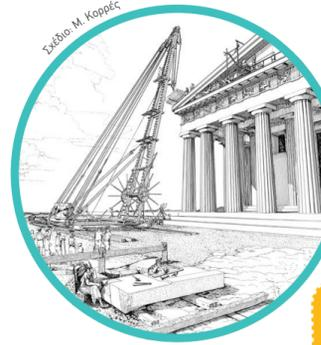
Η **ανύψωση** και η **τοποθέτηση των λίθων** γινόταν με διάφορα μέσα: γερανούς, τροχαλίες με σχοινιά, κυλίνδρους, μοχλούς ξύλινους και χαλύβδινους. Η σταθερότητα του κτηρίου δεν εξασφαλιζόταν με υγρά συνδετικά υλικά (κονιάματα), όπως γίνεται σήμερα, αλλά με την τέλεια επαφή των λίθων, την κατάλληλη διάταξή τους και με τη σύνδεσή τους με ειδικούς συνδέσμους. Ανάμεσα από τους λίθους δεν περνούσε ούτε αέρας.
